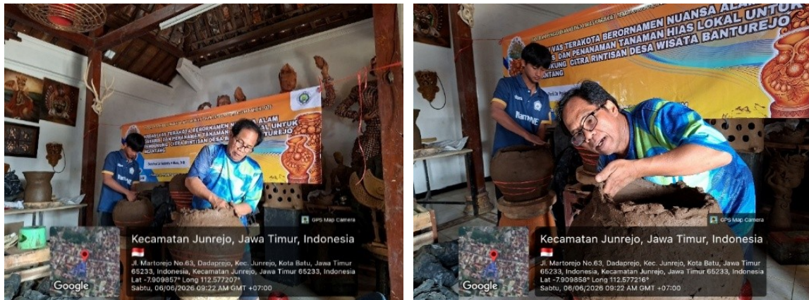
Gambar 5. Proses pembuatan global dasar bentuk vas terakota dengan teknik manual, pijat tekan
